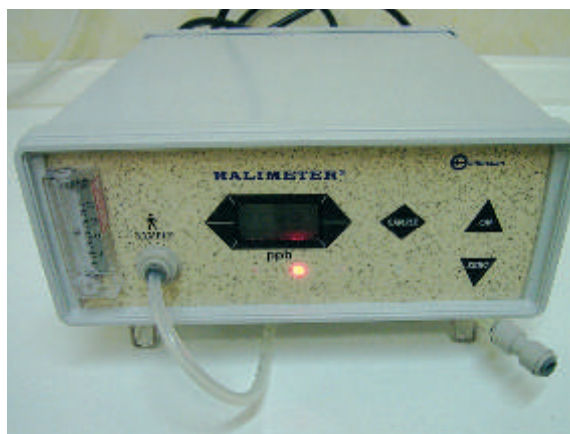
Abb. 2: Das Messgerät Halimeter. Es misst die Schwefelwasserstoffkonzentration im Atem des Patienten.
